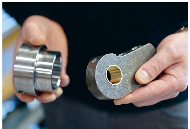
Med säker hand. Kristofer Persson svarvar en innerhylsa till ett fäste.
