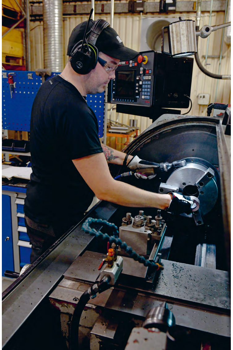
Med säker hand. Kristofer Persson svarvar en innerhylsa till ett fäste.
