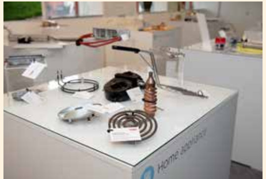
Överst: Operatören Erling Henriksson bockar och klipper plåt till värmepumpar. "Det är sidoplåtar. Men jag gör även vissa delar till kaminer", säger han. Nedanför: Nibe tillverkar en rad olika typer av värmeelement, bland annat till spisar, backspeglar som ska hållas isfria, med mera.
