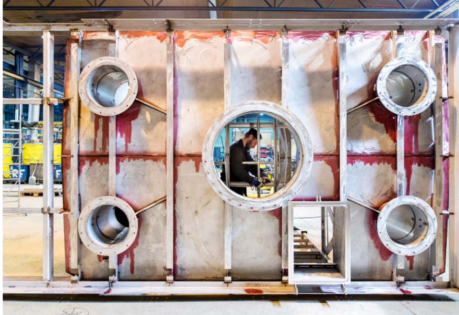
Storlek. Viktor Norberg svetsar på en topp som ska rena rökgaser i ett pappersbruk i södra Sverige. På Stilmek arbetar man inte med finmekanik, här är det större detaljer och mindre serier – ofta enstaka komponenter – som gäller. Andra exempel på tillverkning är kvarnar, krossverk, tankar och containrar.
