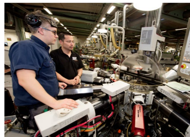
Till vänster: Jimmy Emanuelsson, ställare, och Phong Thanh Vo, operatör, diskuterar vid fabriken modernaste rundbordssvarv – från Pfiffner.
